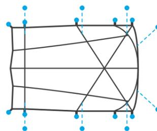
1. フライシートの各ポール端を挿入しているグロメット位置をペグダウンします。
